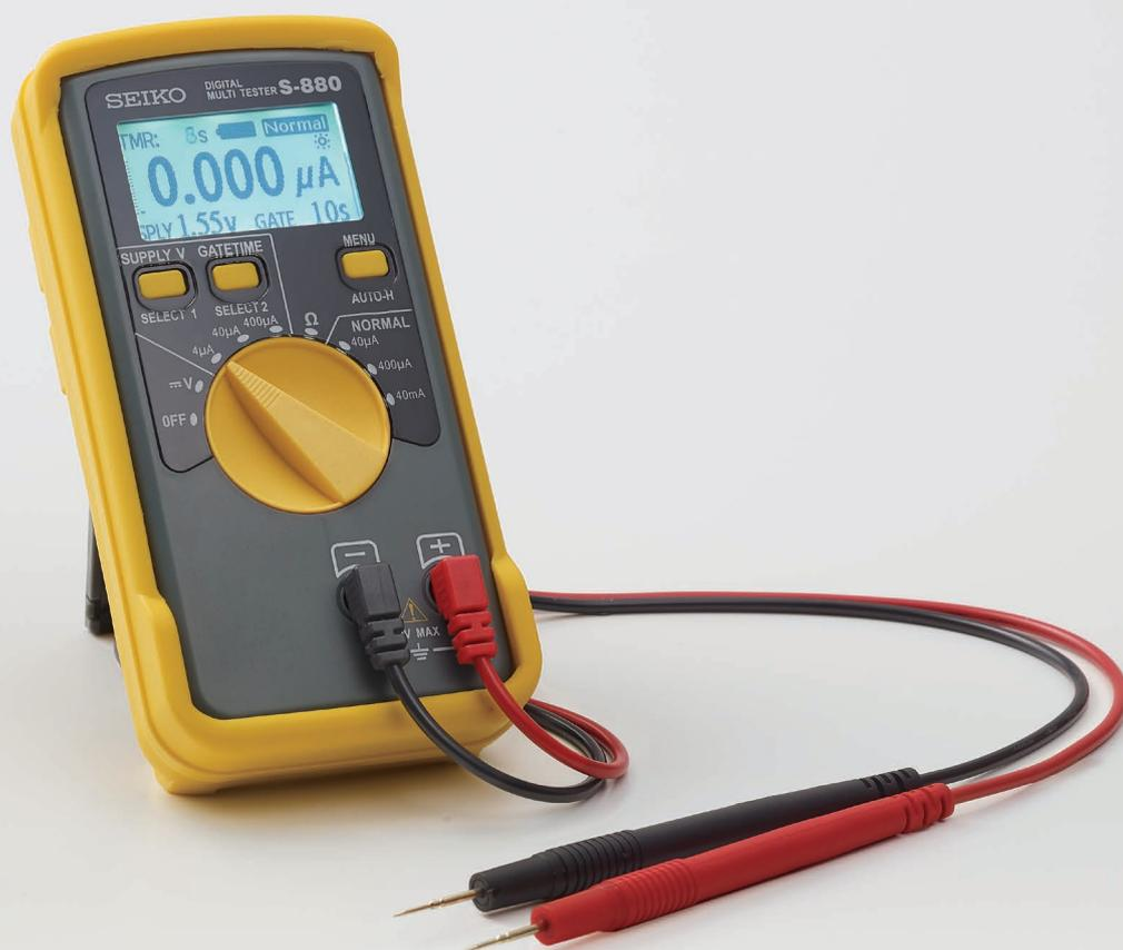
時計の電池電圧測定ができる
