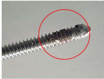
腐食した部品
